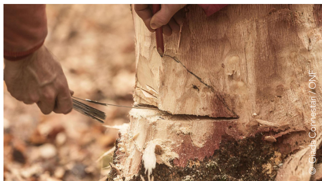
Avec une règle de menuisier, le charpentier mesure la profondeur et trace l'angle de la coupe à poursuivre à la hache.
